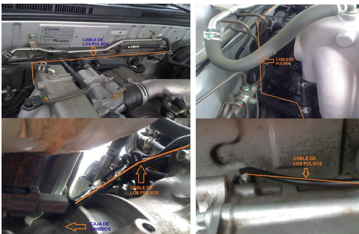
FIGURA 21. Instalación De Los Pulsos Provenientes Del Vehículo. Autor.
