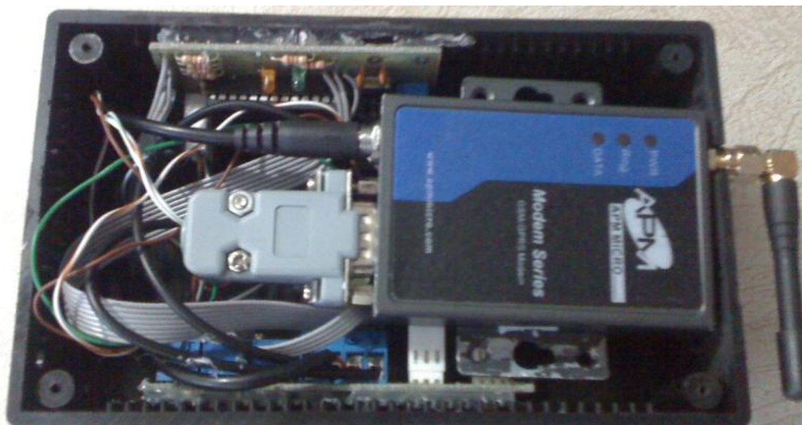
FIGURA 23. Vista Interna Del Sistema Prototipo. Autor.
