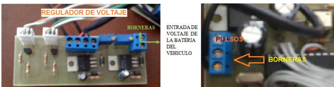
FIGURA 22. Borneras Para La Alimentación Y Entrada De Los Pulsos Al Taxímetro. Autor.
