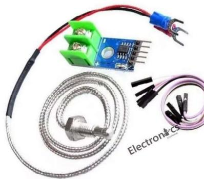
*Figura 11 El módulo Max6675 con termopar tipo J. Imagen proporcionada por mercado libre.*
