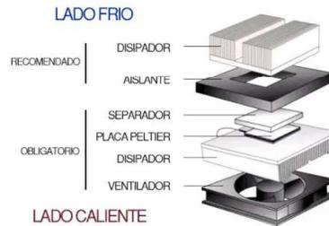
Figura 14 Partes de un módulo Peltier. (Llamas, 2016)
