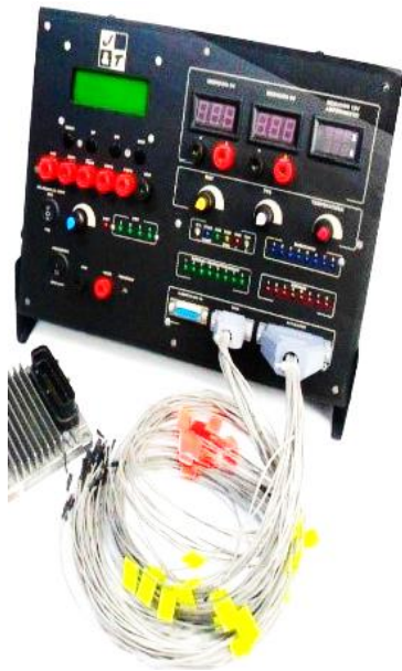
Figura 30 Téster de ECUs para banqueo
