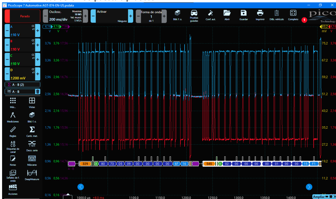
Figura 40 Trama CAN bus de la ECU puesta a pruebas
