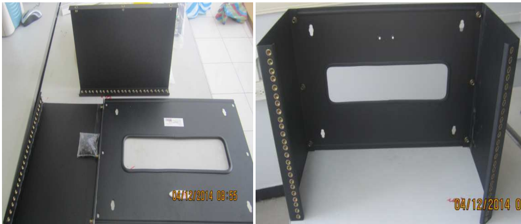
Figura 3.21 Armado de RACK modular de pared Fuente: El autor
