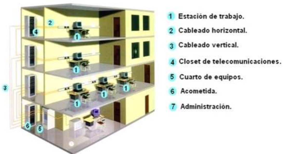
Figura 2.1 Subsistemas de cableado estructurado.
