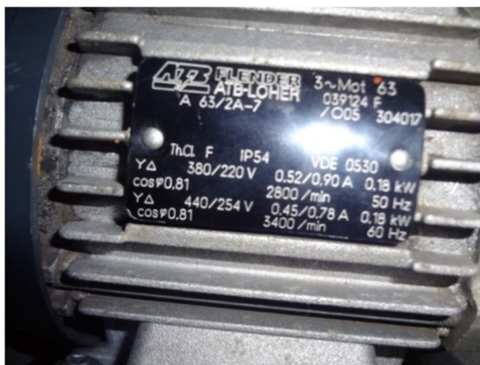
Figura 2.16 Características del Motor Eléctrico Trifásico (Fuente: Autor)
