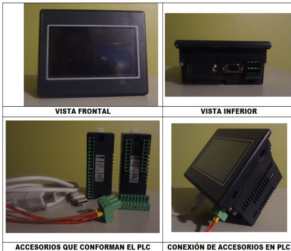
Figura 6.1. PLC + HMI, FlexiPanel FP5043T-E y Accesorios (Fuente: Autor)
