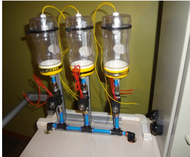
Figura 3.50 Fijación de tanques y ruta para conducción de agua (Fuente: Autor)
