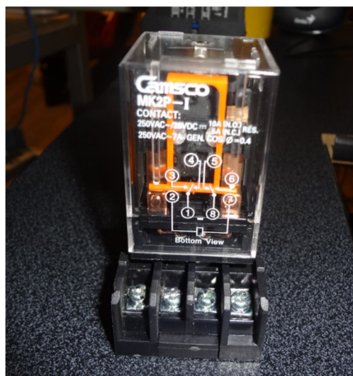
Figura 2.18 Características del Relé de dos contactos (Fuente: Autor)
